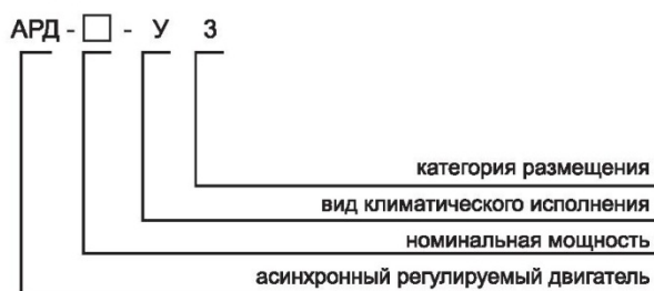
Структура условного обозначения двигателей типа АРД
